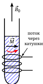
Рис. 14.4. Регистрация сигнала ЯМР. Повёрнутая \pi/2 импульсом намагниченность прецессирует в плоскости xy и создаёт переменный поток через катушки датчика.
