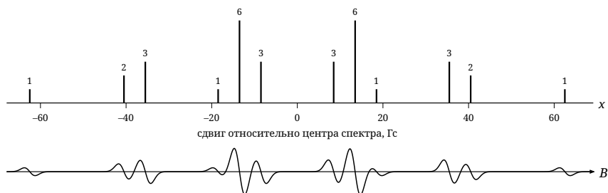
Рис. 10.9. Спектр ЭПР этильного радикала, построенный по рассчитанным координатам: сверху линии с интенсивностями из таблицы, снизу тот же спектр в виде производной поглощения, как его записывает спектрометр.
